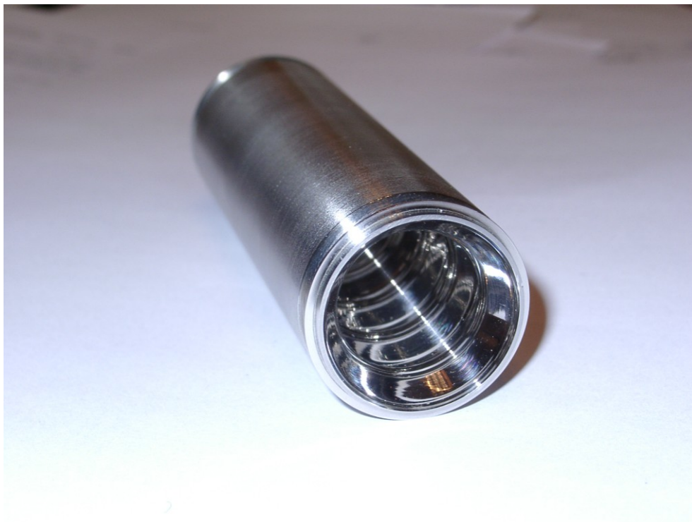
Рис. 64 Фотография замедляющей системы, изготовленной на станке с числовым программным управлением (материал – нержавеющая, немагнитная сталь).
