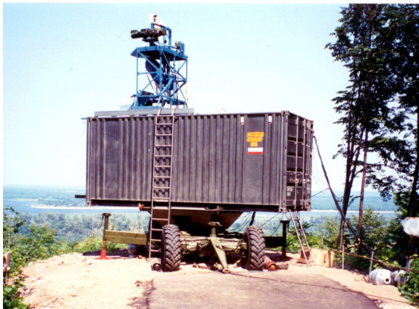
Рис. 86 Внешний вид макета РЛС на основе релятивистского наносекундного СВЧ-генератора в процессе испытаний на берегу Волги.
