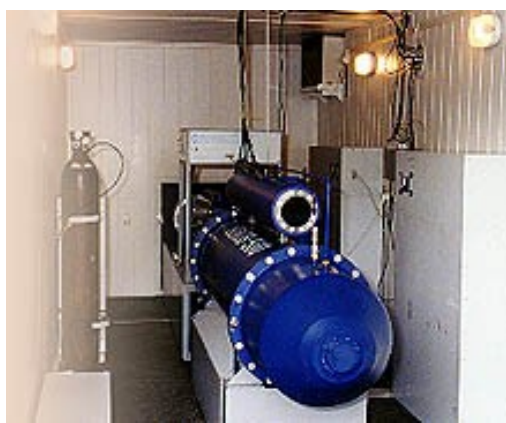
Рис 103 Фотография релятивистского микроволнового генератора на основе ЛОВ, размещённого в транспортном контейнере.
