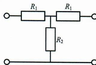
22. Вывести выражение для импеданса токового шунта, схема замещения которого приведена на рисунке. Проанализировать случаи высоких и низких частот.
