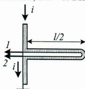
24. Получить выражение для внутренней индуктивности трубчатого токового шунта в коаксиальном варианте (см. рисунок) с внутренним радиусом  $r_{\text{вн}}$ , наружным радиусом  $r_{\text{н}}$  и длиной длинной  $l$ :  $L_{\text{вн}} = \mu_0 l (x^2 - 1 - 2 \ln x) / [(4\pi(x^2 - 1)]$  где  $x = r_{\text{н}}/r_{\text{вн}}$ . Вычислить его постоянную времени  $\tau$ .
