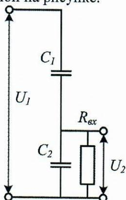
17. Получить выражение для модуля и фазы коэффициента передачи емкостного делителя со схемой замещения, представленной на рисунке.
