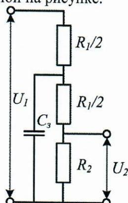
16. Получить выражение для модуля и фазы коэффициента передачи емкостного делителя со схемой замещения, представленной на рисунке.
