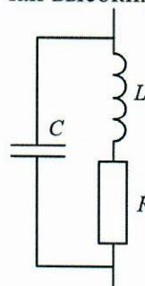
23. Получить выражение для внутренней индуктивности  $L_{\text{вн}} = \mu_0 l b / (2h)$  петлевого токового шунта (см. рисунок), выполненного из шины длиной  $l$ , шириной  $h$  и толщиной  $b$ , при расстоянии между шинами существенно меньшем  $b$ , и  $h \gg b$ . Вычислить его постоянную времени  $\tau$ .
