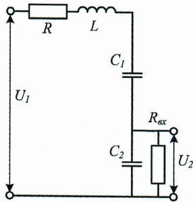
18. Получить выражение для коэффициента деления емкостного делителя, схема замещения которого представлена на рисунке, без учета влияния элементов  $L$ ,  $R$ ,  $R_c$ ,  $R_{bx}$ .
