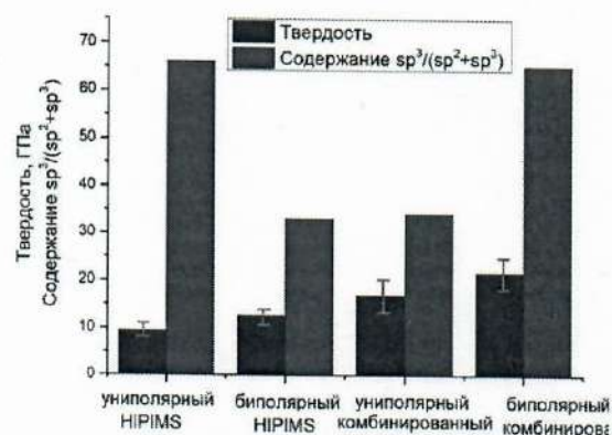
Рис. 10. Твердость и содержание sp^3/(sp^2+sp^3) в углеродных покрытиях.
