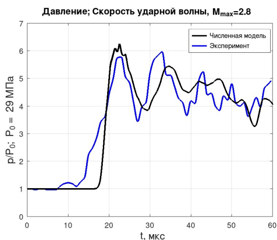
Рис. 2. Импульсное давление в эксперименте с водородом при P_0 = 29 МПа, J_{max} = 975 кА. Синяя линия – эксперимент, черная – результат моделирования методом конечных разностей. M_{max} – максимальная скорость звука в Махах внутри камеры.
