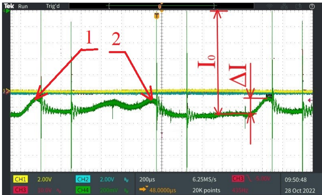
Рис. 4. Осциллограмма сигнала тока с мишени, при токе пучка I_0 = 15 мА и энергии пучка E = 2.5 МэВ. зеленый луч – полный ток мишени. Ноль для зеленого сигнала на осциллограмме располагается вверху; \Delta I = 2.3 мА - величина уменьшения тока мишени. Пик 1 и 2 – это уменьшение полного тока мишени связанного с касанием электронного пучка противоположных сторон отверстий диафрагм.
