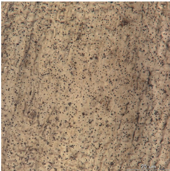
Рис. 2. Изображение поверхности тантала (конфокальный оптический лазерный микроскоп) после воздействия на нее МИИП.
