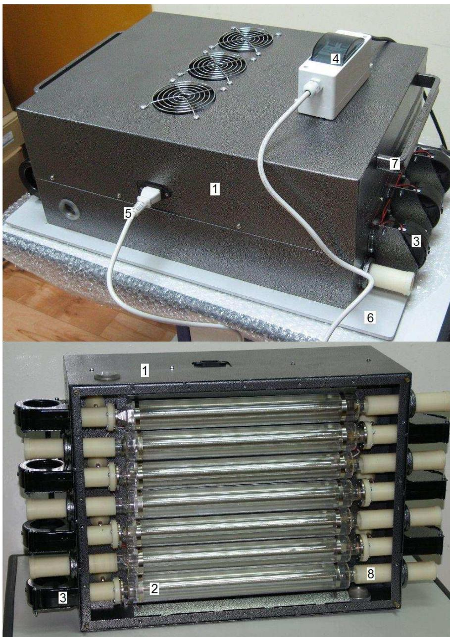
Внешний вид BD\_Cs\_M\_7: 1 – корпус; 2 – семь излучателей; 3 – вентиляторы; 4 – включатель; 5 – сетевой кабель; 6 – фланец; 7 – поручни; 8 – фиксаторы излучателей
